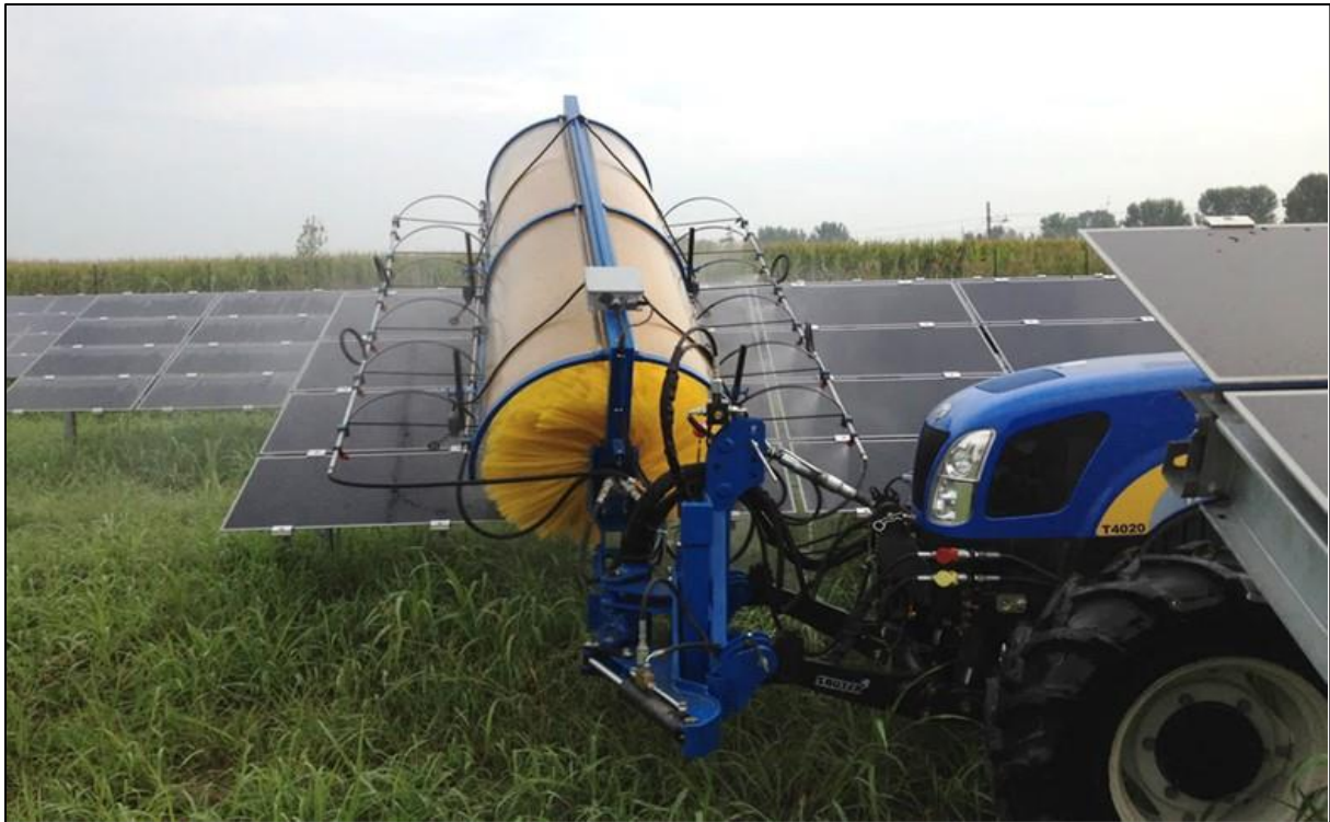
Rysunek 17. Dostawka do ciągnika rolniczego służąca do mycia paneli.
