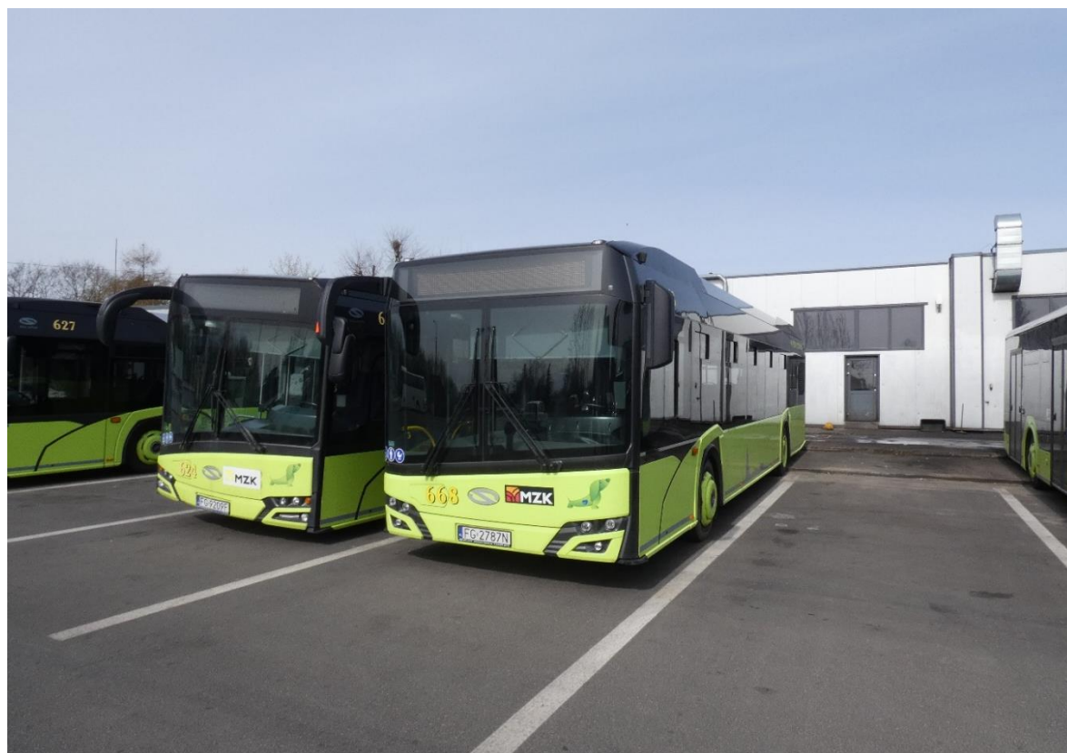
Zdjęcie 33. Solaris Urbino 12 z napędem typu mild hybrid
